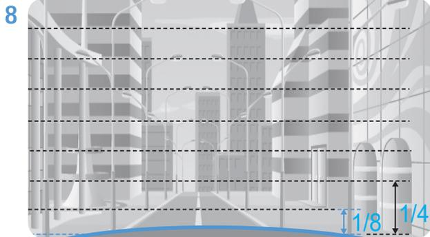
Régalez l'angle de la caméra pour que le capot du véhicule occupe de 1/8 à 1/4 de l'écran lors du visionnement avec Vue en direct sur l'écran ACL, tel qu'illustré à gauche.
