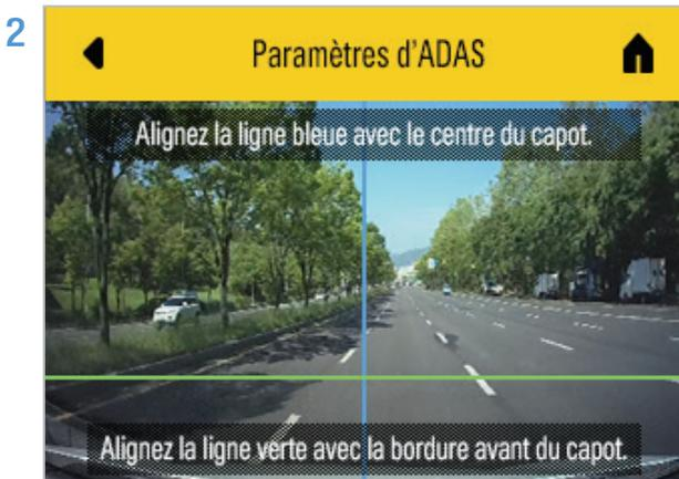
Suivez les instructions affichées à l'écran Paramètres d'ADAS pour régler l'angle de la caméra avant.
